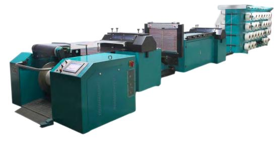
AZF328分丝机是适用于涤纶或锦纶母丝原料的一款高性能整经机。单股母丝由若干根单丝组成,AZF328可极大地节约客户的原料成本,并提升单丝整经效率。分丝机的工作原理为将由独立力矩电机控制的母丝从后牵伸棍上牵出,通过若干道张力辊获得一定的张力,并经过分丝板进行分丝,前牵伸罗拉对分丝后的单丝进行牵伸并控制其张力,最终在车头处完成恒转速收卷整经
